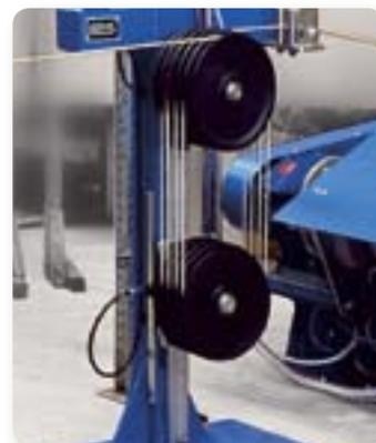
Il gruppo accumulatore a ballerino impedisce ogni sollecitazione eccessiva sul cavo, sia in partenza che in arresto, garantendo un tiro contenuto tra 1,5 e 10 kg. Un sensore di rottura filo ed un freno di non ritorno evitano lo sfilamento della macchina quando cessa l'alimentazione.
