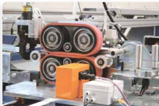
Una volta che la lunghezza prefissata è stata raggiunta, il cavo viene automaticamente tagliato e trasferito da un bobinatore all'altro. La parte iniziale del cavo, tramite un caterpillar motorizzato, avanza automaticamente.
